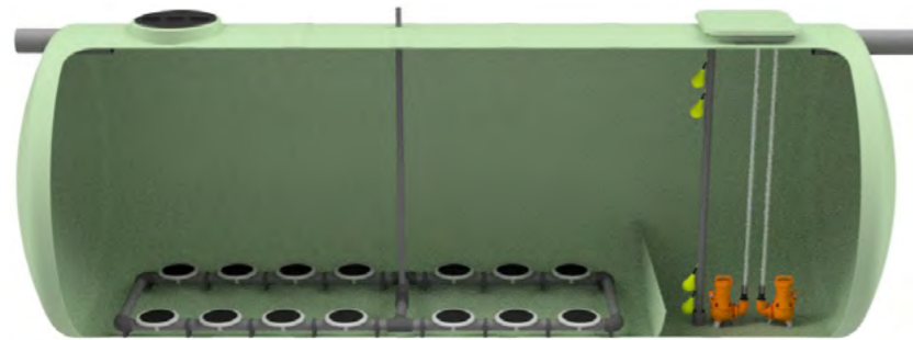
Dibujo Homogeneizador estándar con difusores Homogeneizador standard com difusores
