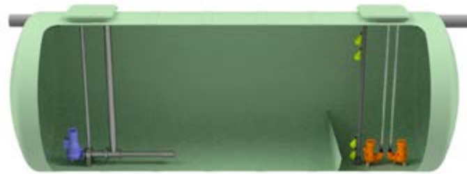
Dibujo Homogeneizador especial con turbina
