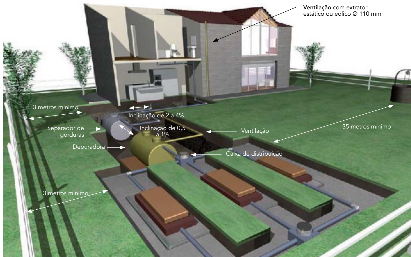
Esquema segundo a norma CEN EN 12566-2
