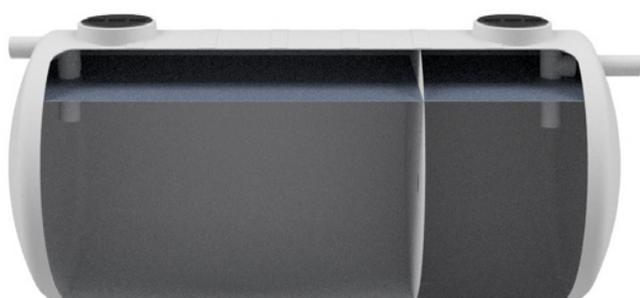
El rendimiento del sistema se estima en un 35% de reducción en  $DBO_5$  y de un 87% de reducción en SS. Estos equipos están especialmente indicados para tratar las aguas residuales de instalaciones en las que no sea necesaria una gran calidad de vertido. También se recomienda su instalación delante de las depuradoras (ROX) para pre-tratar las aguas y aumentar el rendimiento global de la instalación.
