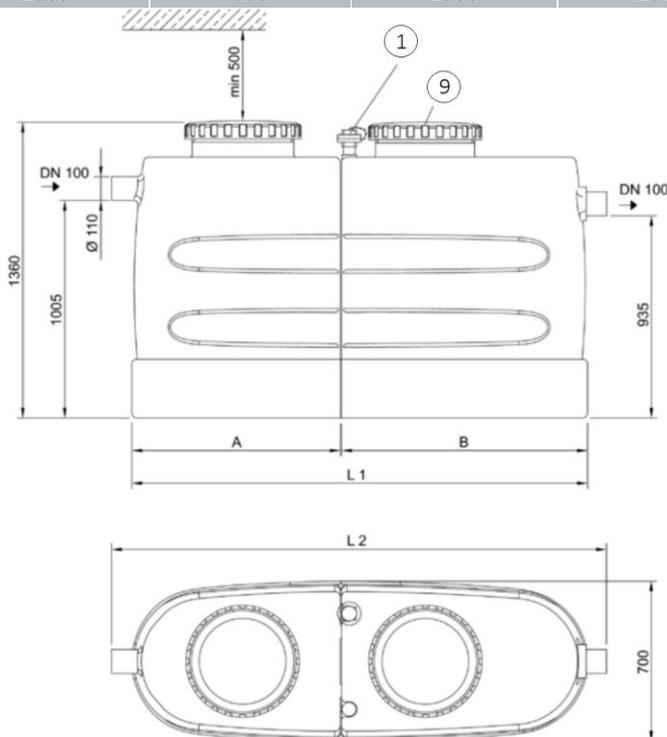
1- Conexión para tubería de succión
