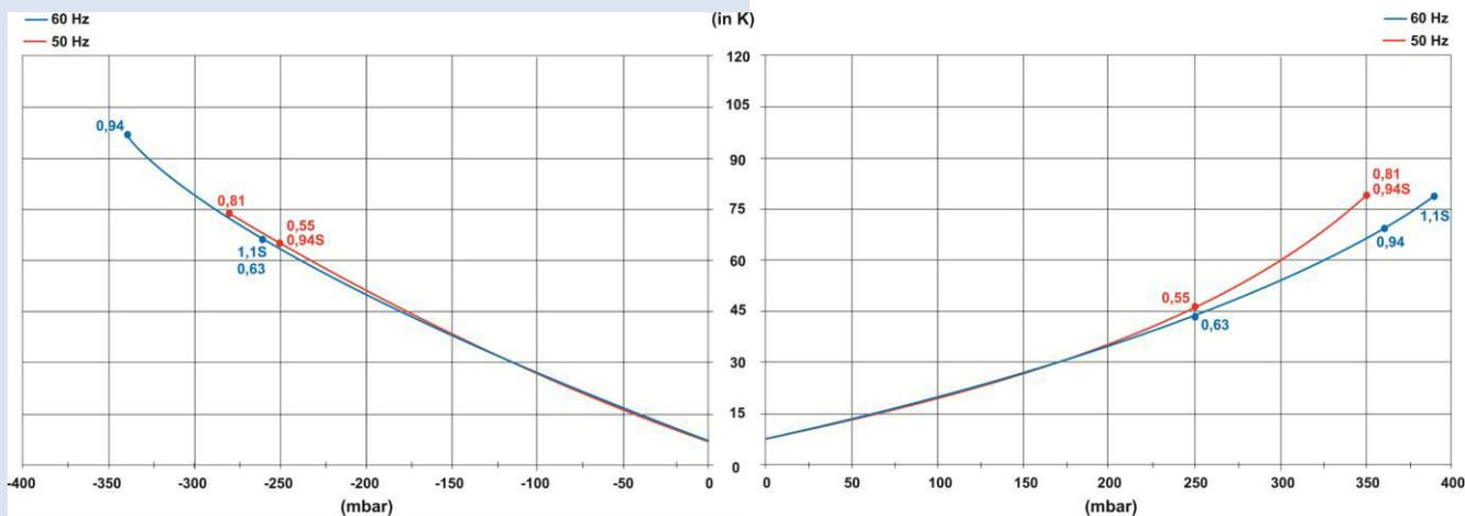
Curvas válidas para operación en continuo con aire a 15°C medido en la aspiración a 1013hPa (mbar abs.) de contrapresión atmosférica, tolerancia: ± 10%; temperatura ambiente: de -20° a +40°C
