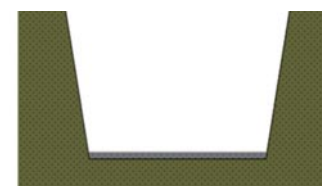
2. Colocación de la placa de base
