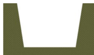
1. Excavación de la zanja
