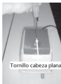
1. Sacar el tornillo de cabeza plana
