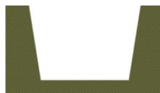
1. Excavación de la zanja
