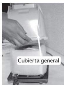
2. Quitar la cubierta general
