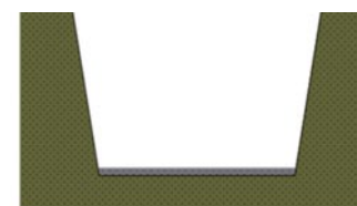
2. Colocación de la placa de base
