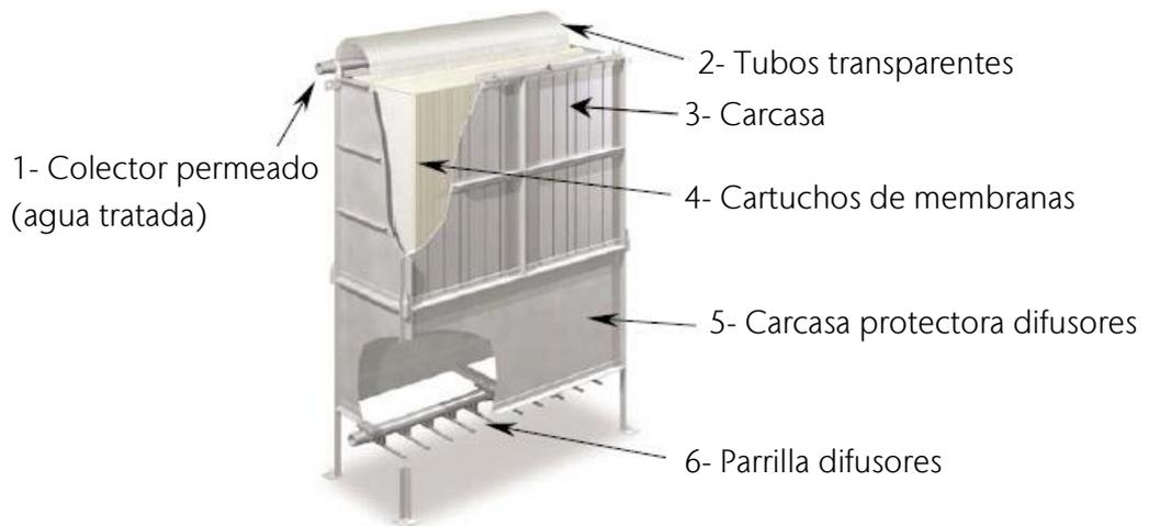
El soplante de las membranas va conectada a un extremo del tubo de la parrilla de difusores (6). En el otro extremo del tubo, se debe instalar una tubería de purga con la electroválvula de purga (ver esquema del tratamiento). Esta electroválvula de purga recibe tensión tanto al abrir como al cerrar.
